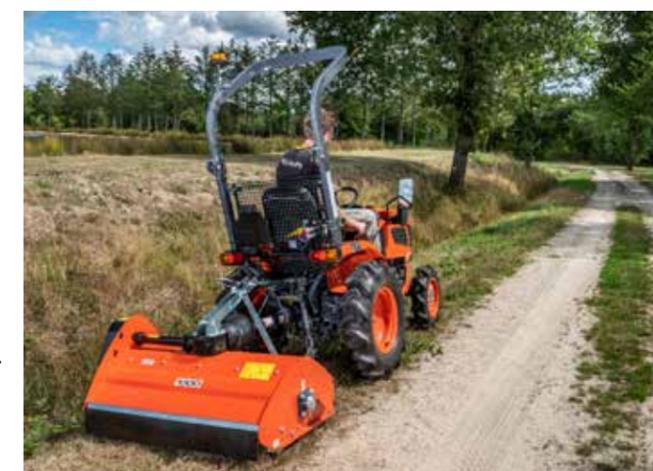
Cette tondeuse à fléaux peut être montée sur un tracteur avec un attelage à trois points seulement, réalisant une excellente coupe d'herbe (mulching).
